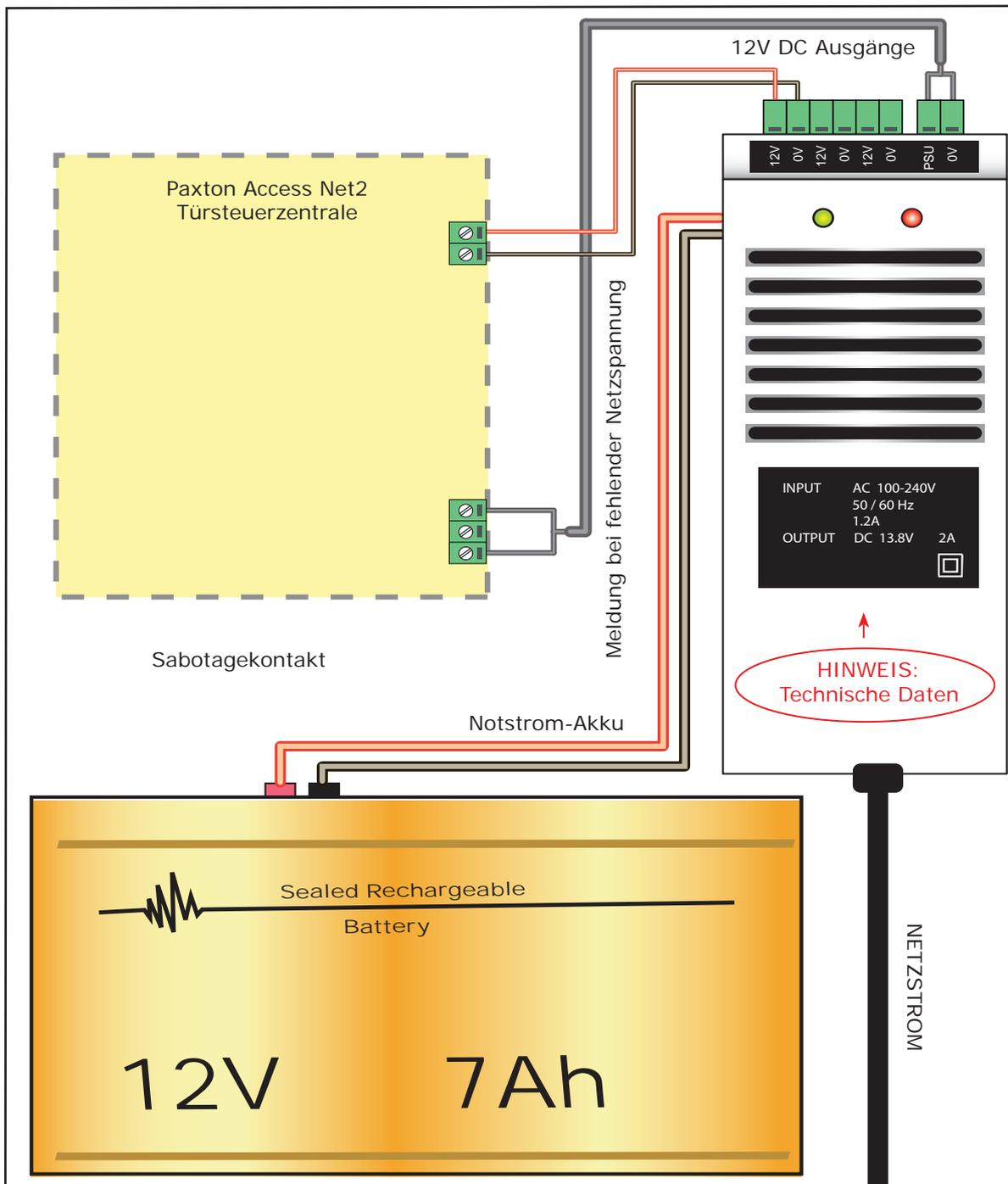
HINWEIS: Der Sabotagekontakt-Typ kann aufgrund unterschiedlicher Gehäusevarianten variieren.
